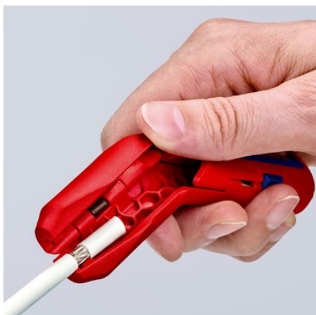
Dégainage d'un câble coaxial
